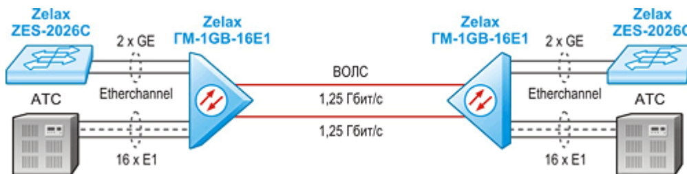
Рис. 2 Совместное использование коммутаторов ZES-2026C и мультиплексов GM-1GB
