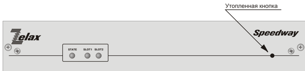
Рис. 20. Вид передней панели изделий MM-20xR-UNI и MM-2xxRC-UNI для установки в конструктив P-12
