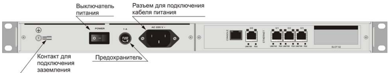
Рис. 30 Вид задней панели изделий MM-225x в металлическом корпусе 19
