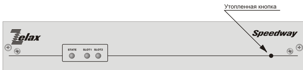
Рис. 16. Вид передней панели изделий MM-22x для установки в конструктив P-12
