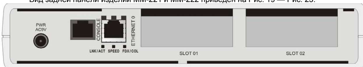
Рис. 21. Вид задней панели изделий MM-221x-AC9 и MM-222x-AC9 настольного исполнения с питанием от сети переменного тока
