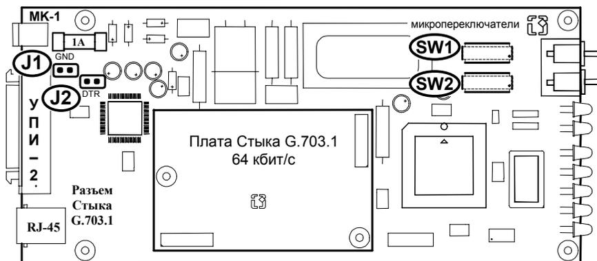
Рис. 5 Расположение элементов на плате конвертера
