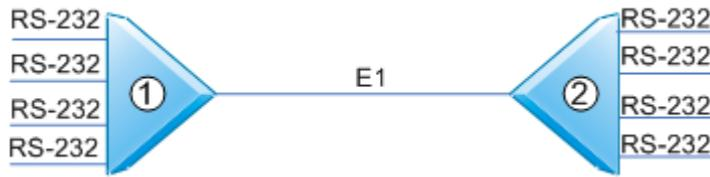
**Рис. 37 Передача данных RS-232 через поток E1 в режиме мультиплексирования**
