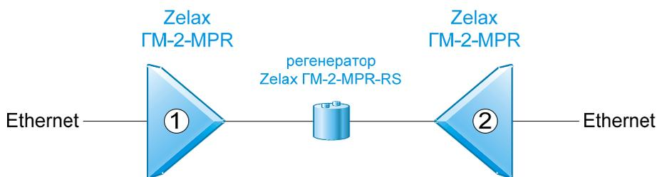
Рис. 36 Передача данных Ethernet по одной медной витой паре в режиме моста с использованием регенератора
