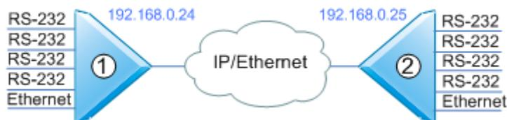
Рис. 40 Передача данных RS-232 и Ethernet через IP/Ethernet
