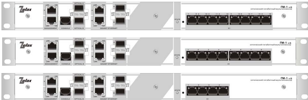
Рис. 11. Передние панель мультимплексера ГМ-1Gx-16E1-T, ГМ-1Gx-8E1-T и ГМ-1Gx-4E1-T
