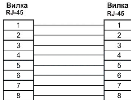
Схема соединительного кабеля A-002. Длина кабеля 2 м
