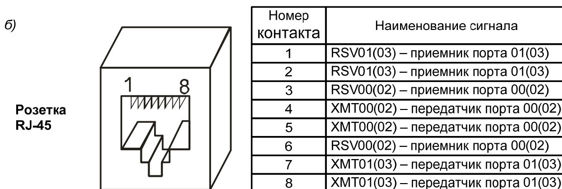
Рис. 7. Назначение контактов разъема порта модулей “E1A”
